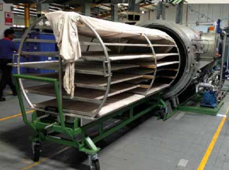
Vakuum-Druckdämpfer zum Entspannen, Stabilisieren bzw. Fixieren von Textilien aus Natur-, synthetischen oder Mischfasern (z. B. Strickwaren und Feinstrumpfhosen).
